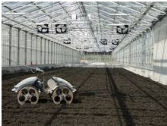
Figure 4 – Photo d'un lit de séchage sous serre avec sanglier électrique (Thermo System)
