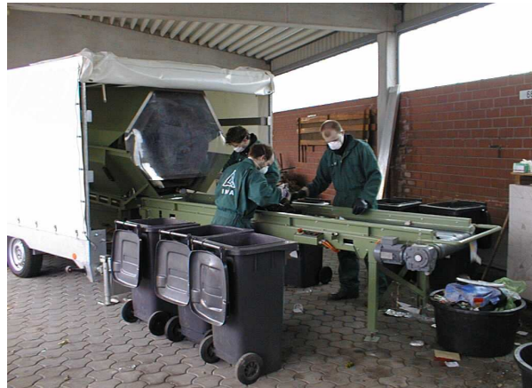
Abbildung 4: Beispiel für eine manuelle Sortierung unter zur Hilfenahme einer Siebmaschine [Flamme, 2008]
