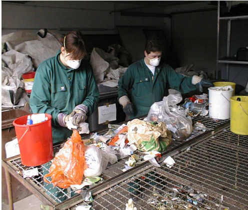
Abbildung 3: Beispiel für eine manuelle Sortierung mit Hilfe eines Sortiertisches [Flamme, 2008]
