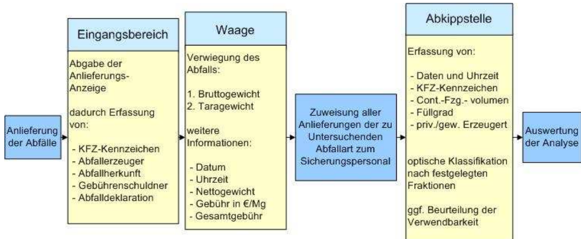
Abbildung 6: Fließschema einer Sichtung (Beispiel) [Flamme, 2008]
